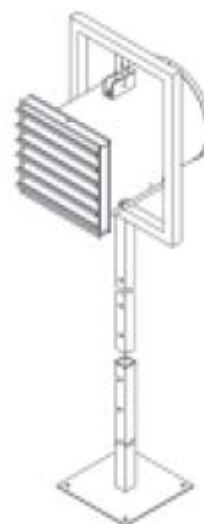
Slika 4 – Oprema za podium, opcija CK21 Podesuvacka sevkupna visina od 1800 mm do 3050 mm (mora da se zacvrste na stabilna povrsina ili platforma)
