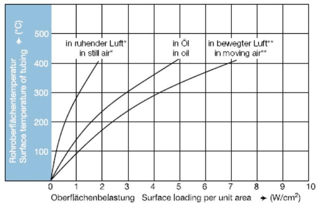
Rohrflächen-temperaturen bei unterschiedlichen Luftgeschwindigkeiten und einer Umgebungstemperatur von 20 (°C)
