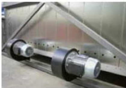
Indirektno razladuvanje sto se naoga zad izolacijata za namaluvanje na turbulencijata vo kelijata na peckata
