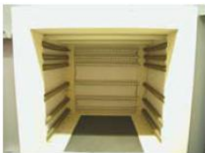
Vnatresnost na niskotoplinskiot zicen materijal za zacuvuvanje na toplinata za brzo razladuvacko vreme vo LF modelite
