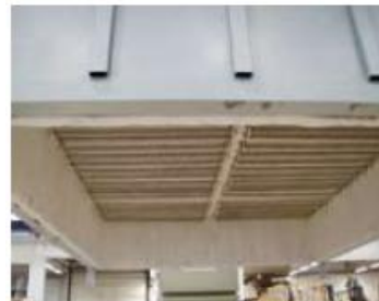
Grecki elementi instalirani vo pokrivkata na peckata
