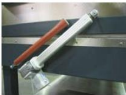
Avtomatski otvor na pokrivkata so elektromagnetno vreteno
