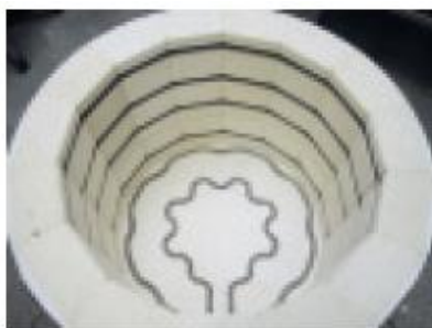
Zastitliv ekran sto se naoga vo prednicata na greackite elementi za zastita od mehanicka steta
