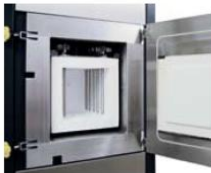
Kelija konstrirana od keramicki vlakna
