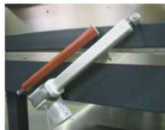
Avtomatski voden poklopec kako dodatna oprema
