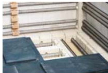
Grecki elementi na kadata zastiteni od SiC plocki za da se kreira ramna površina za polnenje
