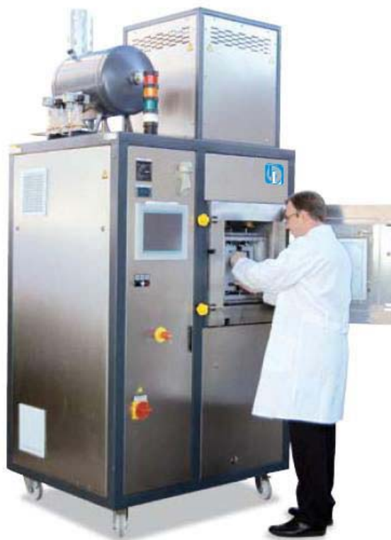
VHT 08/16 MO so H 2 –prodolzitelen paket kako avtomatska verzija
