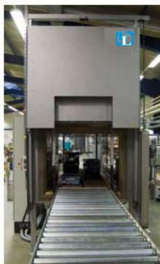
N 1680 / 45 so kruzen transporter sto e implementirano vo produkcjonata linija
