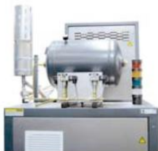
N_2 - Sistem za itno procistuvanje i fakel za H_2 - operacija
