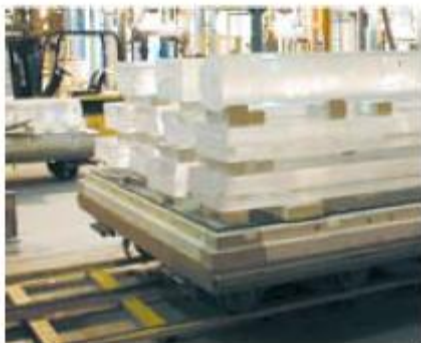
Shuttle pecka so dimenzii po poracka za manipulacija na kvartzni pracki
