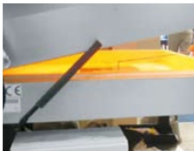
Insuliracki pridusuvaci na gas so dobri dimenzii za polesno otvaranje na peckata
