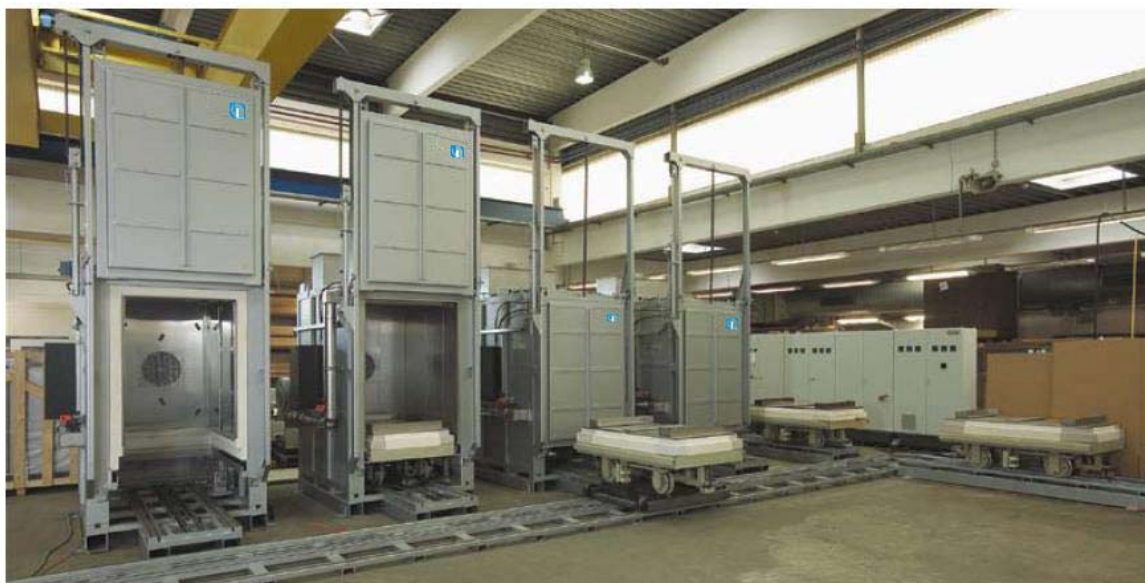
Celosno avtomatiziran sistem na keliski pecki so naprecno tranverzna kolicka i avtomatizirana zamena na tovarot so tenkite sokarni kelii
