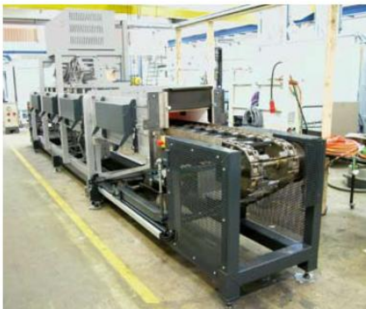
Prodolzitelna pecka so transportni singiri sto e vo produkcija
