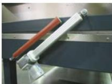
Avtomatsko otvaranje na pokrivkati so elektromehaničko vreteno
