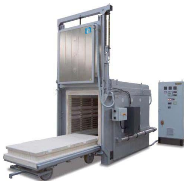
Shuttle Pecka W 2060/S sprema baranjata na kupuvacot bez potreba od greenje na lokomotiva za zagrevanje na napravenite kalapi
