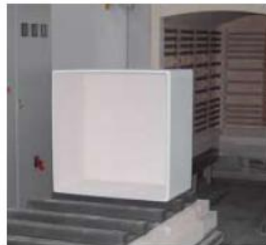
Shuttle Pecka W3300 za glaziranje ili topenje na sadovi za koristenje vo solarnata industrija
