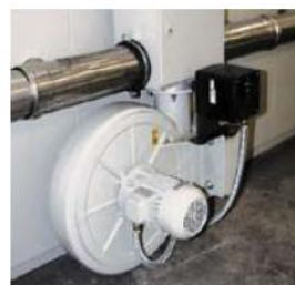
Razladvacki sistem za pokratki cikliracki vremenja
