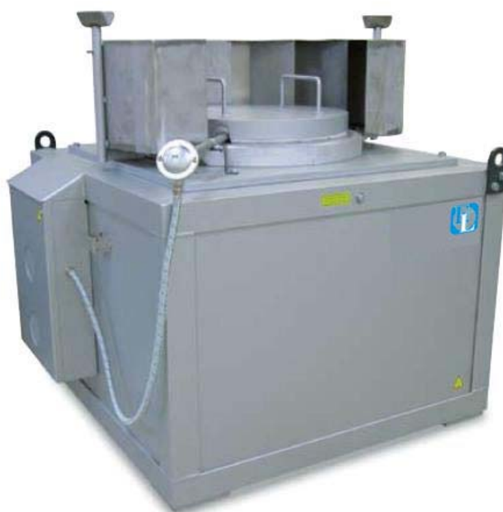
TS 40/30 so izduven gasovna cevka so rabovi na kazanot za odvod
