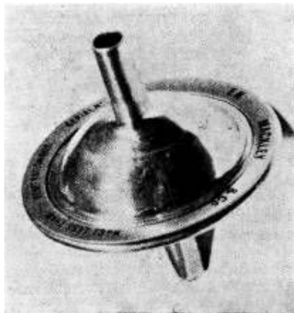
Sl. 2. Filtar pogodan za zapremine vazduha do 20 l/minut
