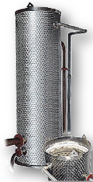
Razmenuvacot na toplina prikazan vo ovoj prospekt e namenet za destilacija na alcohol.Izveden e kako ceven,protivstруен-vertikalnen.Na baranje na klientite,Electrolux PALENZO –INOX izrabortuva cevni razmenuvaci na toplina od site tipovi i kapaciteti.
