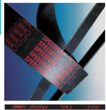
Durch seinen endlosen Kabelkord-Zugstrang, der zwischen zwei textilverstärkten Deckbändern eingebettet ist, vereint der TEXROPE® SPEEDFLEX® hervorragenden Kraftschluss, Flexibilität und hohe Festigkeit. Dank seiner Elastizität werden die Stoß- und Achsbelastungen reduziert. Der in drei Festigkeitsklassen lieferbare Riemen kann mühelos an die Anforderungen des jeweiligen Antriebs angepasst werden.
