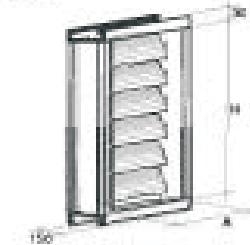
Nepovratna klapna služi za sprečavanje prestupavanja vazduha kad sistem ne radi. Može biti montirana na usisnoj ili potisnoj strani klima sistema. Ram je izrađen od podinkovanih lima odgovarajuće debeline, a lopatice su od aluminijumskog lima.
