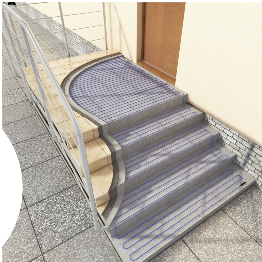
Postavljanje jednostrano napajanih ELEKTRA VCD25 grijaćih kabela
