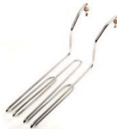
074 // 305000 Cr-Ni // ø 8.5 mm // 220 V // Rekor: M12 b 305000 4000 W A: 80 mm B: 370 mm H: 280 mm B1: 110 mm
