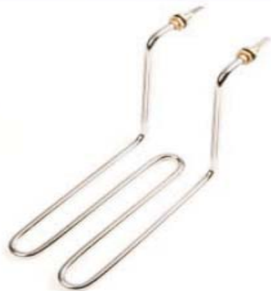
075 // 20186 Cr-Ni // ø 8.5 mm // 220 V // Rekor: M12 b 20186 2700 W A: 91 mm B: 235 mm H: 180 mm B1: 45 mm 20183 2500 W A: 115 mm B: 235 mm H: 175 mm B1: 35 mm
