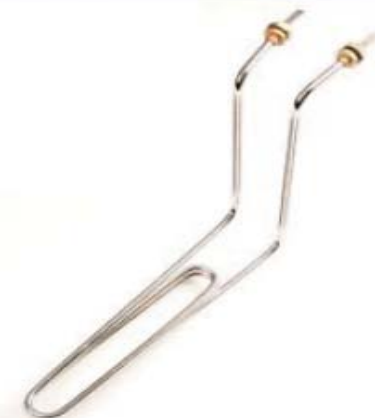
077 // 20357 Cr-Ni // ø 6.5 mm // 220 V // Rekor: M12 b 20357 1800 W A: 28 mm B: 230 mm H: 240 mm B1: 60 mm
