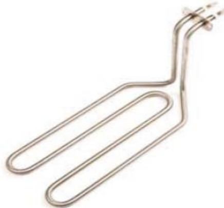
076 // 20166 Cr-Ni // ø 8.5 mm // 230 V 20166 2000 W A: 20 mm B: 260 mm H: 140 mm B1: 55 mm
