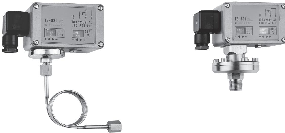
Tlačno stikalo TS-831 je namenjeno za regulacijo pritiska plinov in tekočin z veliko viskoznostjo, ter umazane fluide, posebej primerni za agresivne medije v prehrabni in farmacevtski, kemični, petrokemični in procesni industriji. Sestavljajo jo kovinska membrana, mehanizem za nastavljanje območja preklopa, ter mehanizem za določanje diference preklopa. Največja dovoljena prekoračitev pritiska je 20% od maximalne nazivne vrednosti.
