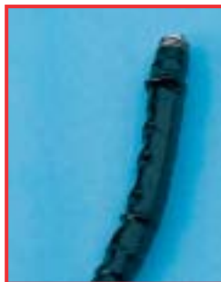
Bubrenje na distalnom kraju fibroskopa
