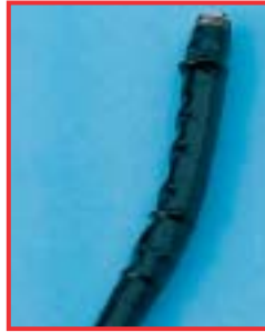
Bubrenje na fleksibilnoj cijevi zbog korištenja neodgovarajućeg sredstva za njegu
