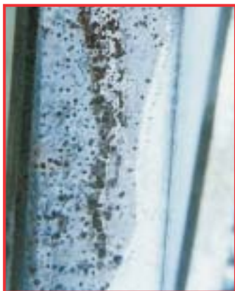
Naslage na instrumentu uzrokovane tvarima koje sadrže kloride
