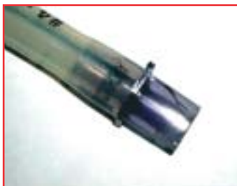
Pukotine zbog naprezanja
