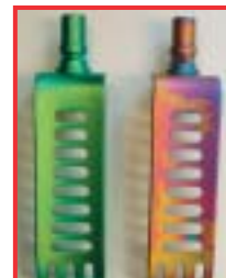
Lijeva valva: potpuno nova - cijela jednako zelena Desna valva: strojno čišćena - šareno promijenjena boja
