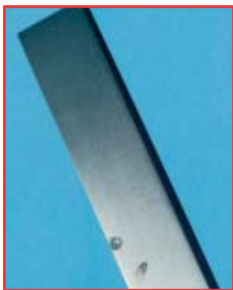
Korozija na dlijetu
