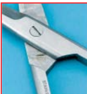
Nagrizajuća korozija zbog nedovoljnog podmazivanja
