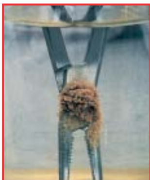
Korozija uzrokovana potapanjem instrumenta u fiziološku otopinu na nekoliko sati
