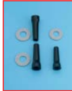
Nabubrene brtve kao posljedica nepažljive i neprecizne aplikacije ulja za podmazivanje
