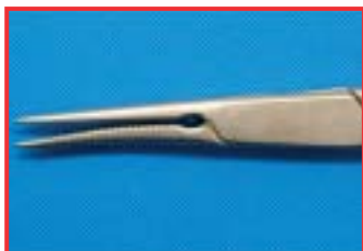
Deformacije uzrokovane nepravilnim rukovanjem
