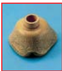
Pukotine na masci uzrokovane starenjem
