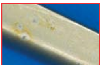
Mrlje i oštećenja na instrumentima uzrokovana kloridima
