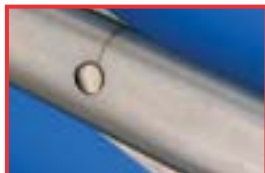
Mikropukotina uz zglob škara
