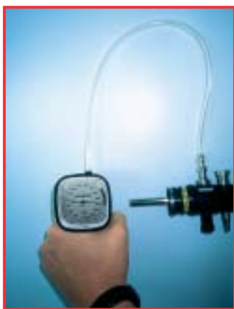
Provjera fleksibilnog endoskopa na propuštanje
